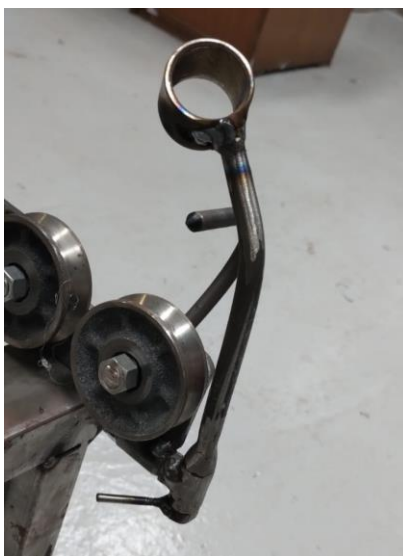
Figura 8 – Suporte da tocha depois da revisão. Fonte: Autoria própria (2023)
