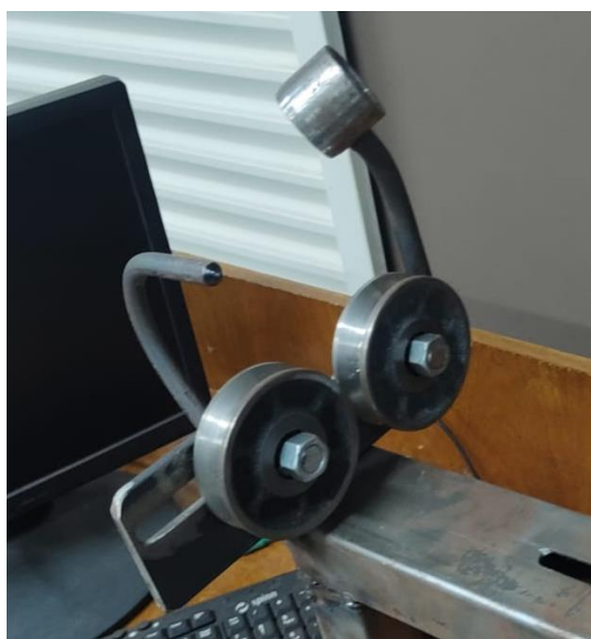
Figura 7 – Suporte da tocha antes da revisão. Fonte: Autoria própria (2023)
