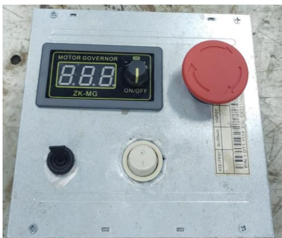
Figura 13 – Adicionado botão de emergência ao painel Fonte: Autoria própria (2023)
