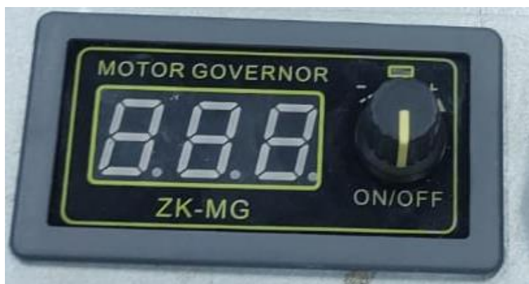
Figura 6 – Controlador de rotação do motor elétrico. Fonte: Autoria própria (2023)
