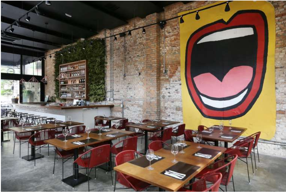
Figura 15 - iluminação estruturada em trilhos com spots e pendentes de cobre, MéZ Restaurante
