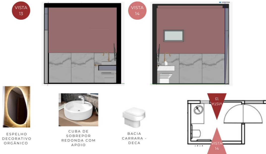
Figura 82: Detalhamento dos materiais, Banheiro, laterais
