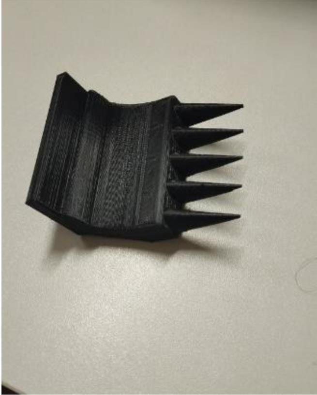
Fig 4- Defesa/Ataque, parte frontal do carrinho com esteira
