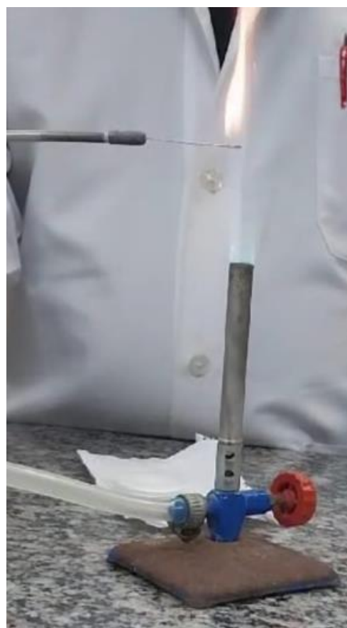
Figura 5. teste de chamas sendo efetuado. Na imagem, é possível ver a queima de uma amostra sendo feita.
