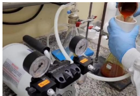
Figura 2: Filtração a vácuo do lote 1
