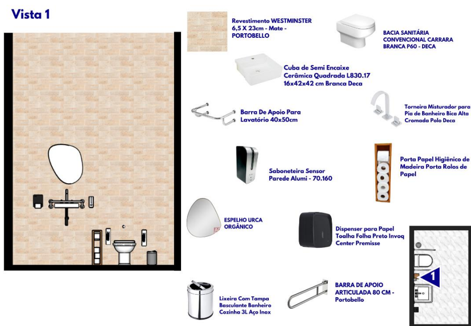
Figura 40 - Detalhamento de materiais - Banheiro: Vista 1
