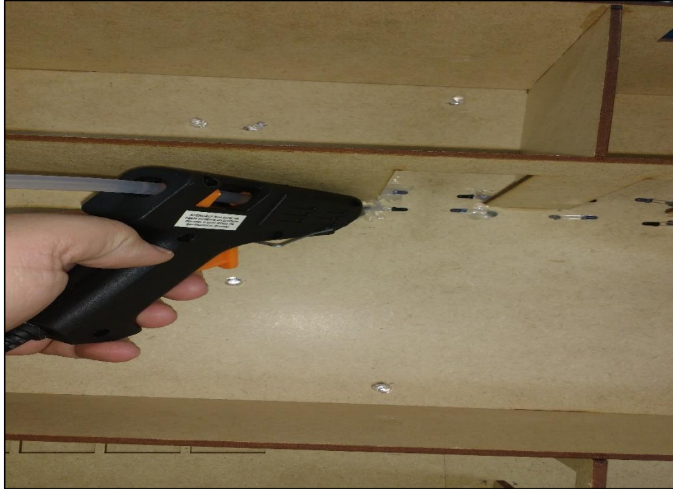
Figura 3.6 – Fixação dos sensores
