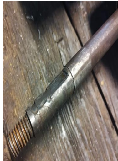
Figura 5 – Eixo da roda desgastado
