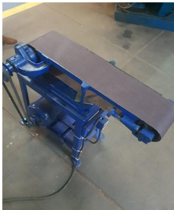
Figura 10: Lixadeira de cinta finalizada
