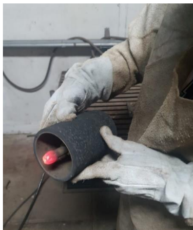
Figura 7 – Eixo preenchido de solda
