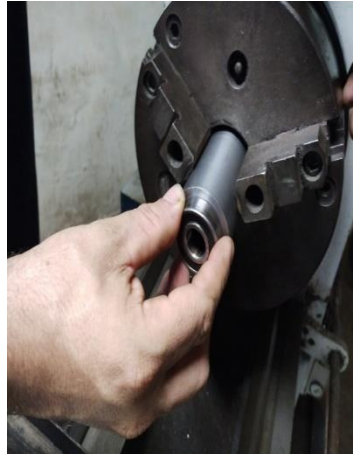
Figura 6 – Verificação do encaixe no diâmetro do rolamento
