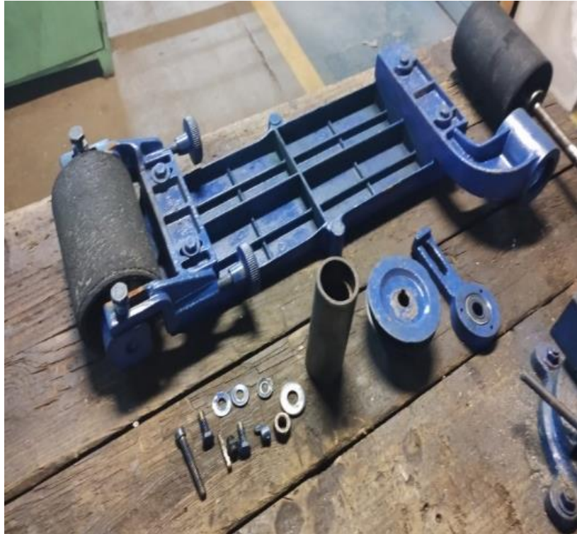
Figura 3 – Lixadeira de Cinta desmontada
