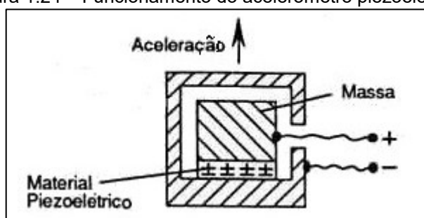
Figura 1.24 – Funcionamento do acelerômetro piezoelétrico
