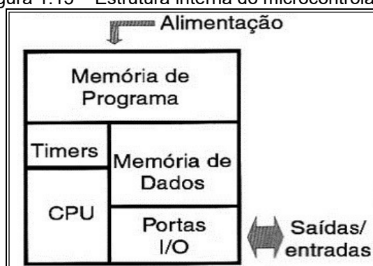
Figura 1.15 – Estrutura interna do microcontrolado/r
