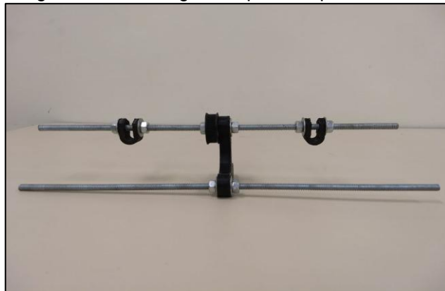
Figura 3.5 – Montagem da primeira parte da base
