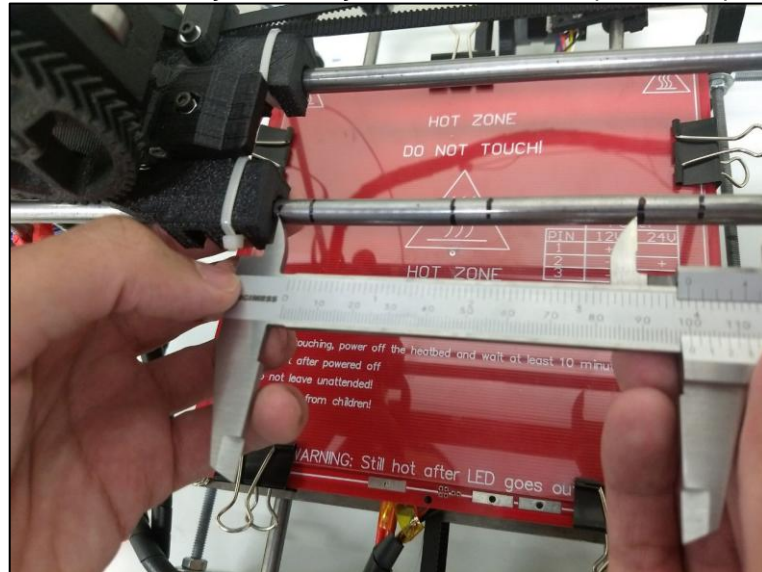
Figura 3.32 – Calibração e medição nos eixos da máquina de impressão
