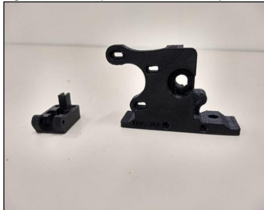
Figura 3.16 – Suportes do extrusor ajustados
