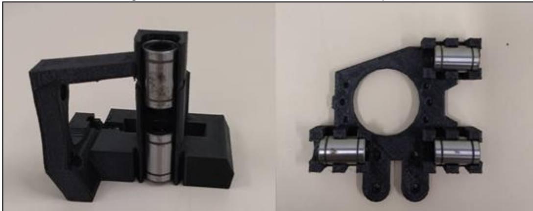
Figura 3.13 – Encaixe dos rolamentos nos suportes
