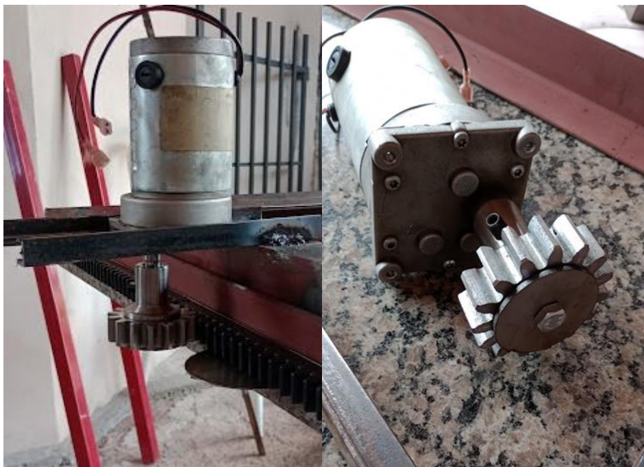
Figura 3: Montagem do Motor
