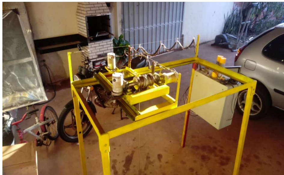
Figura 14: Ponte Rolante finalizada
