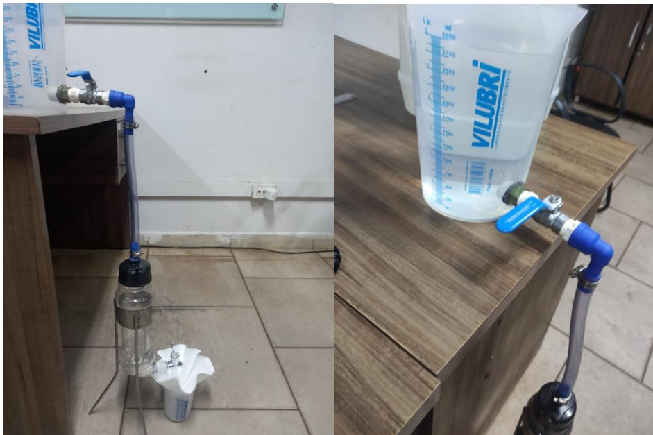
IMAGEM 5: Prototipo de adsorção com carvão ativado
