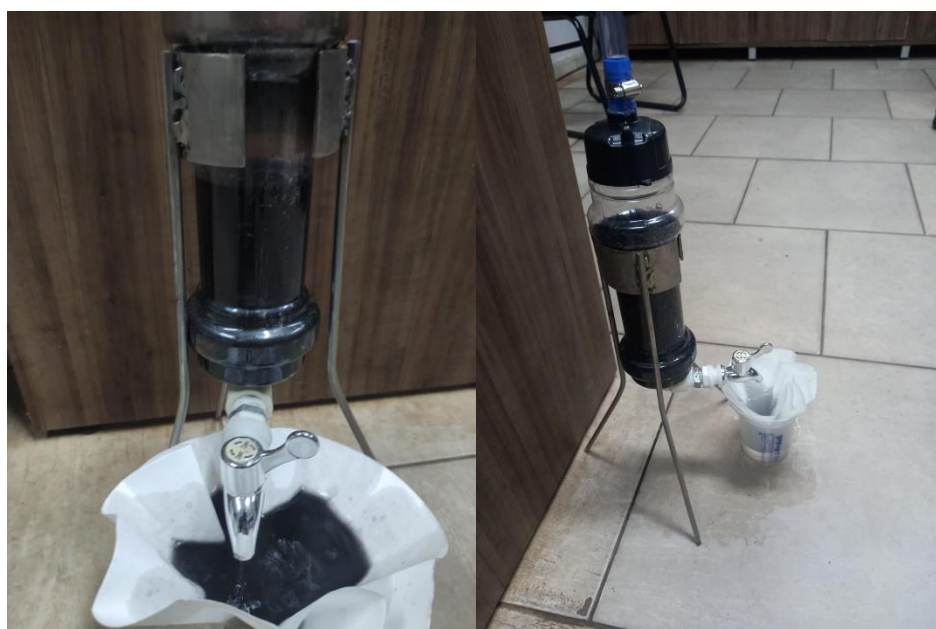
IMAGEM 7: Protótipo de adsorção com carvão ativado
