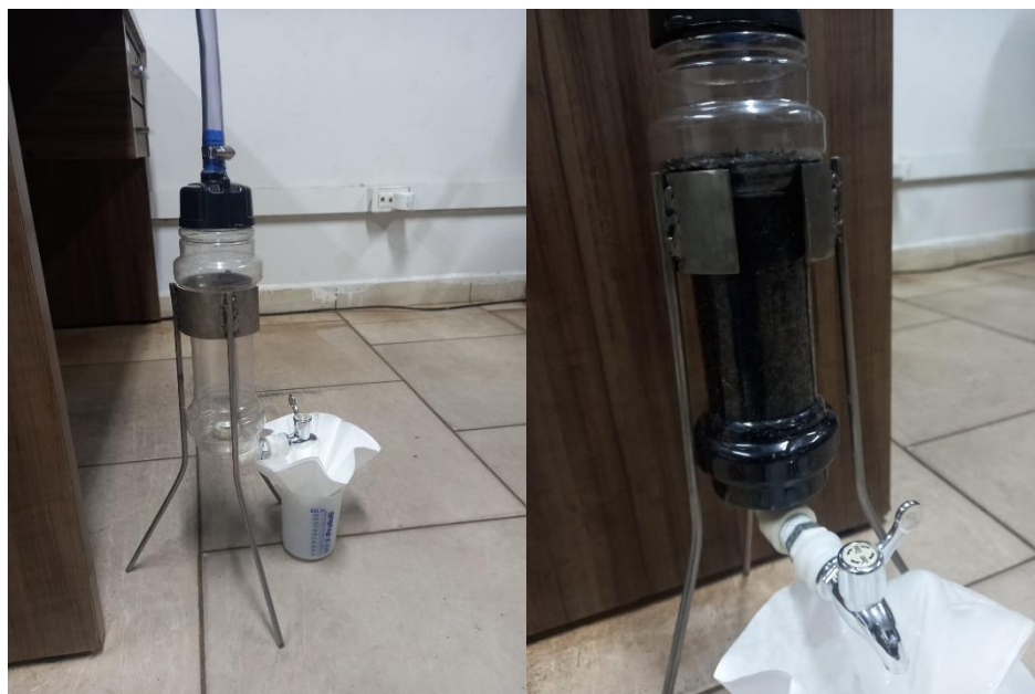
IMAGEM 6: Protótipo de adsorção com carvão ativado
