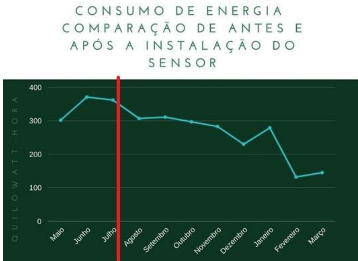
Figura 25 – Representação em gráfico do consumo de energia, a linha vermelha indica o período de instalação do sensor (fim do mês de julho - 2023).
