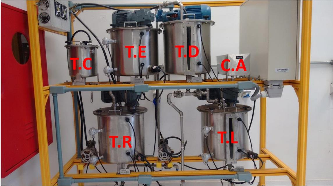
Na figura anterior tem-se que as siglas T.C, T.E, T.R, T.D, C.A e T.L são tanque catalizador, tanque de entrada, tanque de reação, tanque de decantação, caixa de água e tanque de lavagem, respectivamente.
