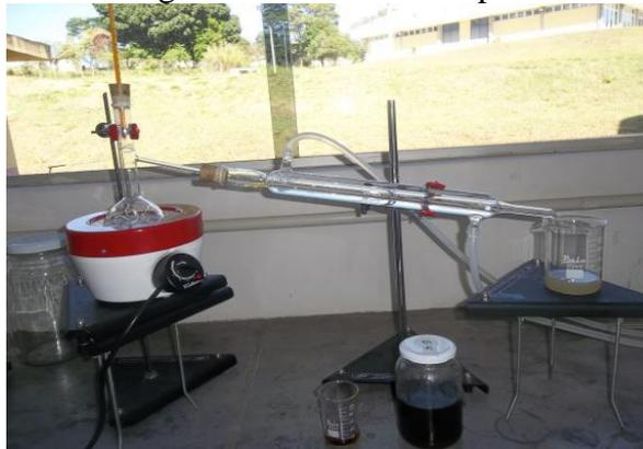
Para a destilação comparativa serão preparadas duas soluções para teste, uma alcalina utilizando Hidróxido de Sódio (NaOH) 0,5M e uma ácida com Ácido Clorídrico (HCl) 0,5M. A unidade de medida padrão usada foi mililitros (ml).
