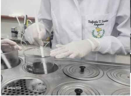
Posteriormente à homogeneização dos elementos, foi utilizado um bastão de vidro para agitar manualmente a fórmula até atingir a consistência esperada. Em seguida, o composto foi colocado em um agitador/ mixer Fisatom para acertar a espessura desejada.
