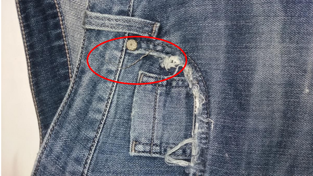
Figura 14 - Exemplo de peça com defeito Linha Estourada
