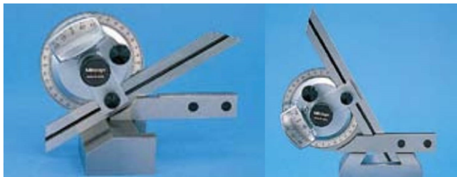
Figura 17: Exemplo de Medida de ângulo com goniômetro
