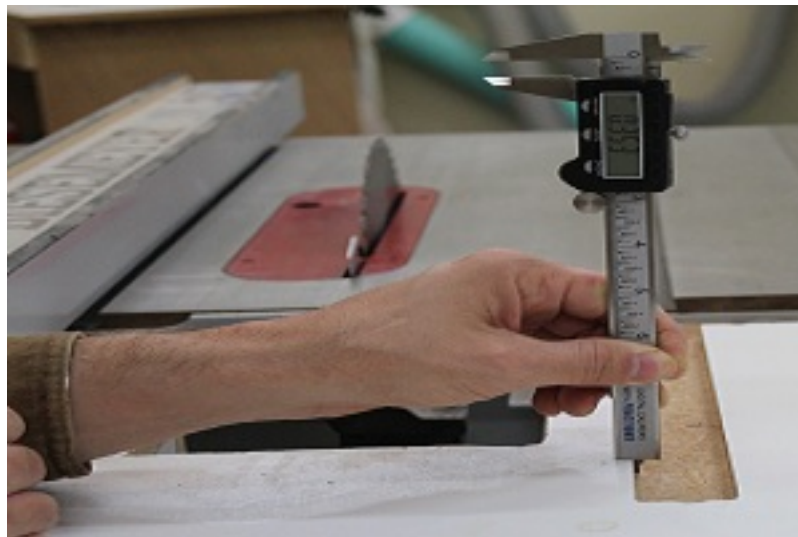
Figura 19: Exemplo de Medida de aba com quando valor deve ser obtido pelo vértice
