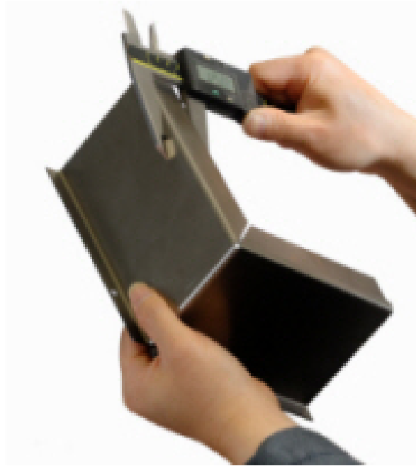
Figura 19: Exemplo de Medida de aba com quando valor deve ser obtido pelo vértice
