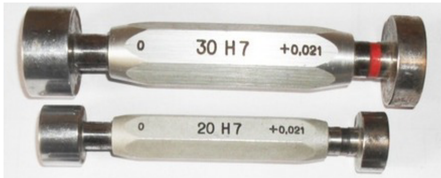
Figura 12: Dispositivo Passa não passa para furos
