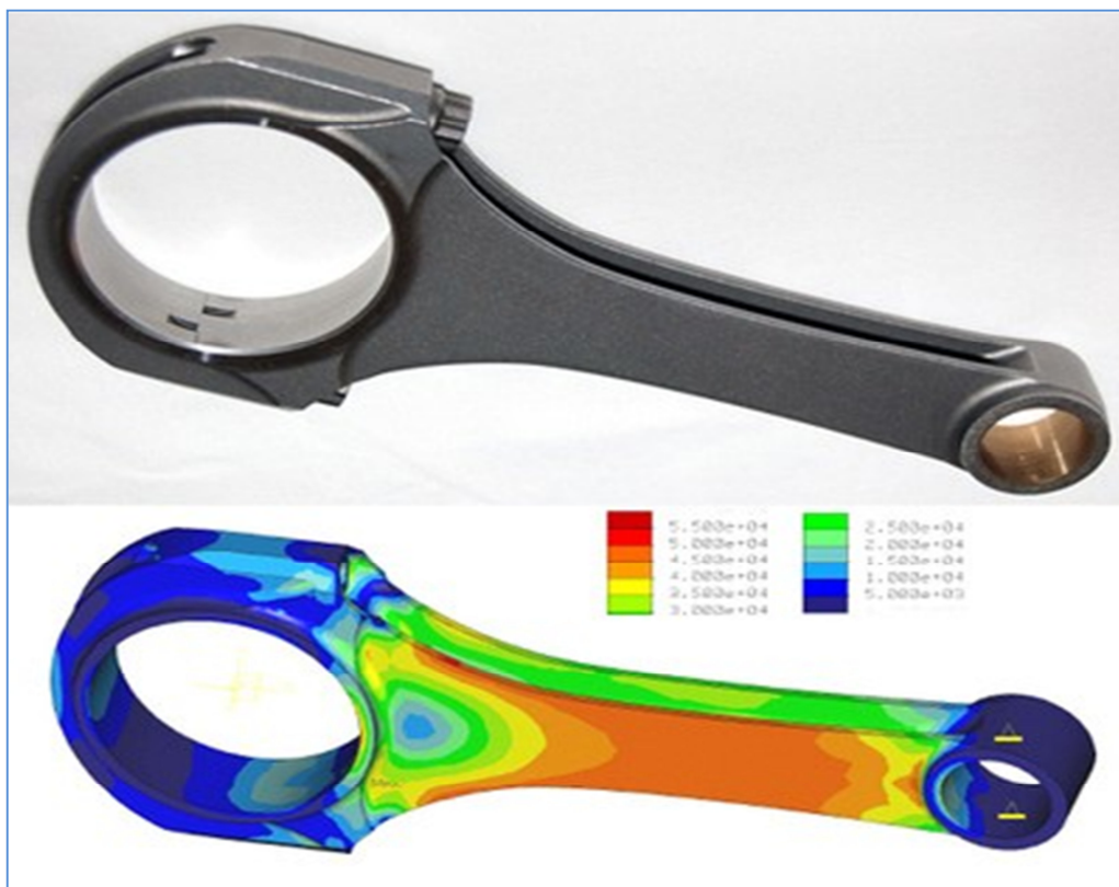
Figura 31 – Análise de resistência (sistema CAE) de um componente mecânico indicando os pontos de uma possível ruptura por fadiga
