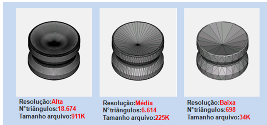
Figura 22 – Comparação de diferentes resoluções da malha de triângulos
