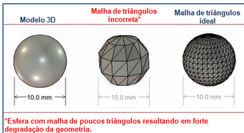
Figura 23 – Comparação da resolução correta e incorreta da malha de triângulos
