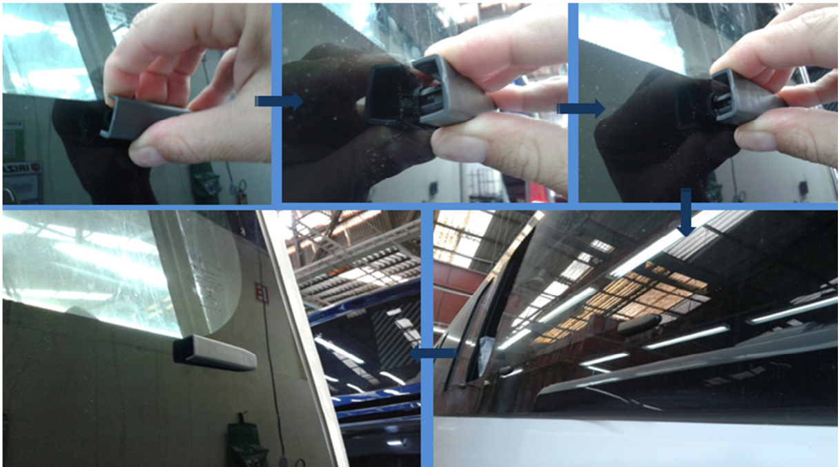
Figura 50 – fixação do “escoa água” através da climpagem
