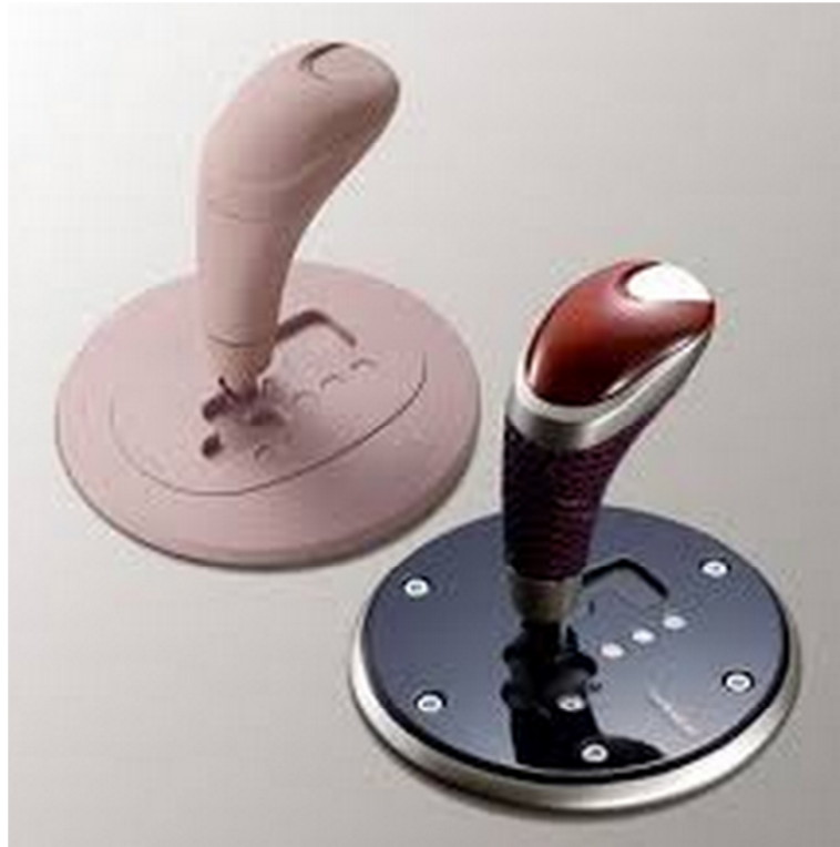
Figura 32 – Protótipo funcional x Protótipo físico de uma alavanca de cambio automático
