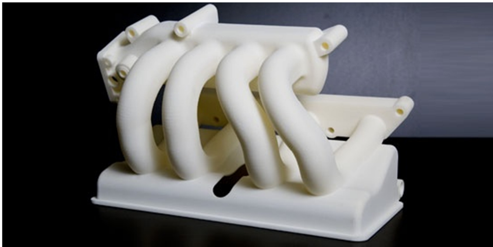
Figura 12 – Impressão em SLS de um componente de motor resistente ao calor
