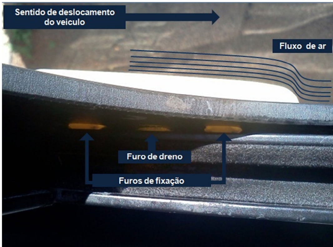
Figura 42 – Esquema de funcionamento do “escoa água”-lado interno
