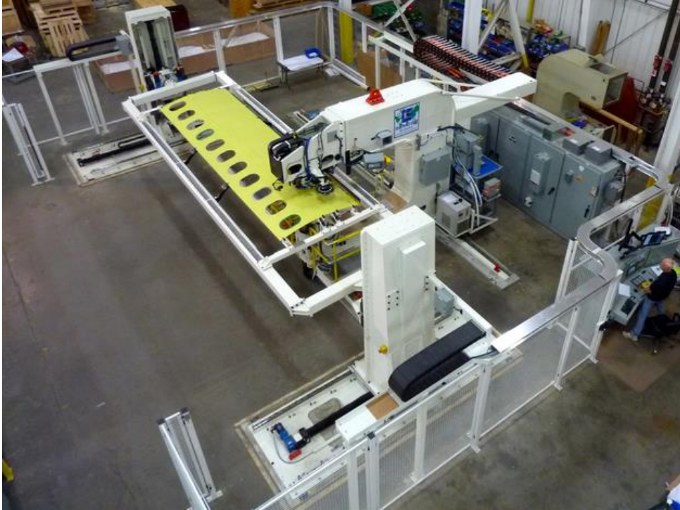
Figura 6 - Fuselagem sendo cravada pela Rebitadora Automática Gemcor
