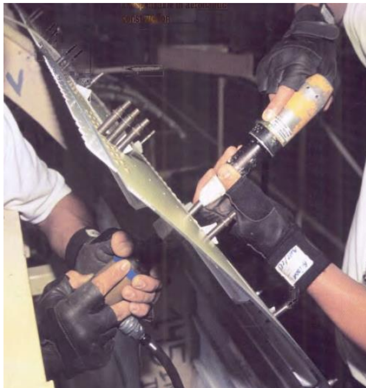
Figura 24 - Rebite manual com martetele e barra de encontrar
