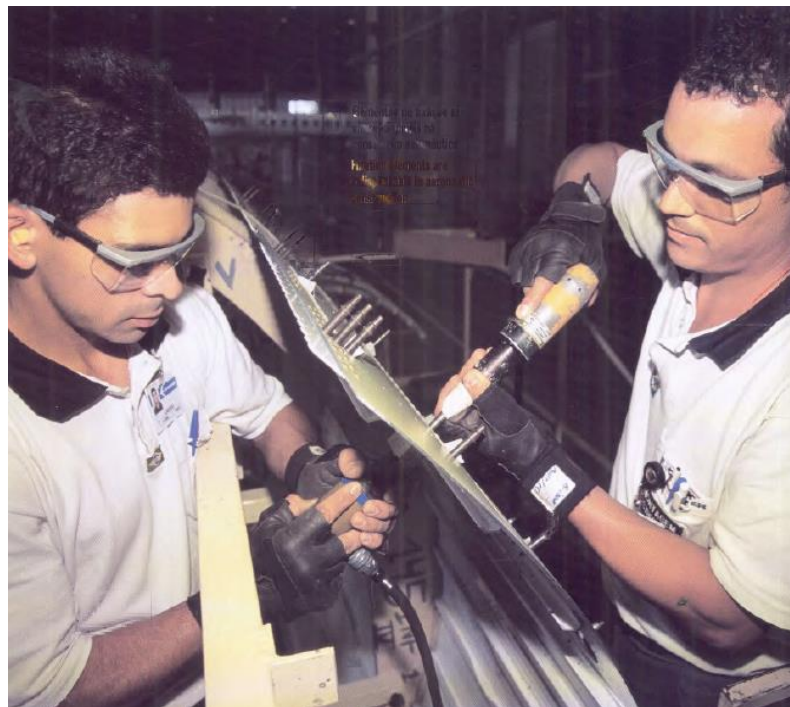
Figura 12 - Rebitagem manual com martelletes
