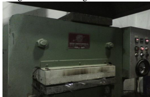
Figura 14 - Prensagem do colchão
