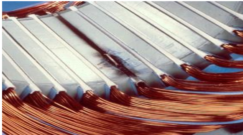
Figura 12- Bobina em curto-circuito para massa no interior da ranhura
