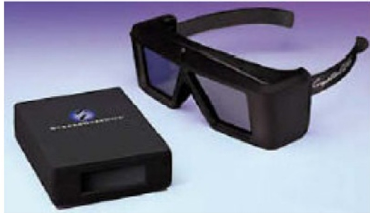
Figura 2. Óculos com lentes de LCD utilizado na técnica de estéreo ativo
