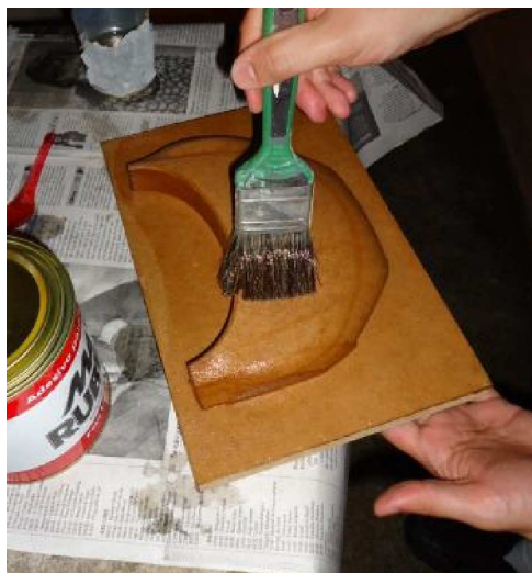
Figura 23 – Aplicação de Resina.
