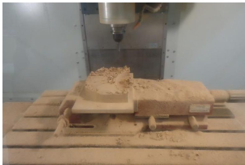
Figura 20 - Processo inicial de usinagem (contorno).
