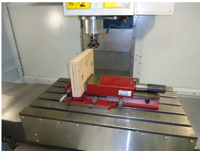
Figura 17 - Operação faceamento das laterais.
