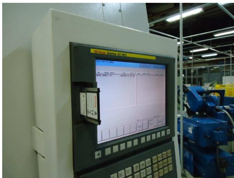
Figura 19 - Transferência dos arquivos gerados pelo software MasterCam.
