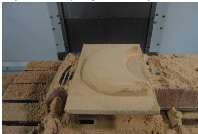
Figura 21 - Finalização do processo de usinagem de detalhes.
