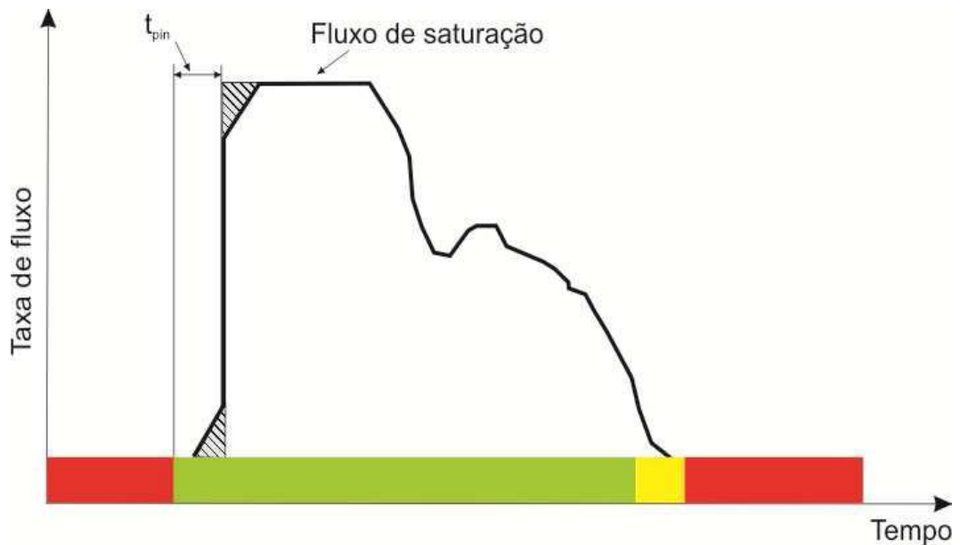
Figura 5. Fluxo de saturação e tempo perdido inicial em estágio não saturado.
