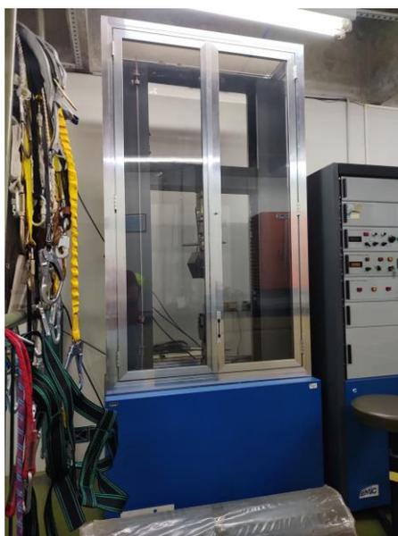
Máquina utilizado para ensaio da tração das argolas do cinto de segurança
