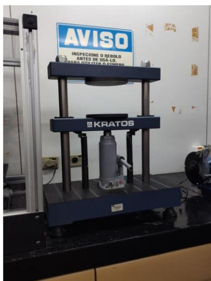
Equipamento utilizado para ensaio da resistência de óculos de proteção e argolas
