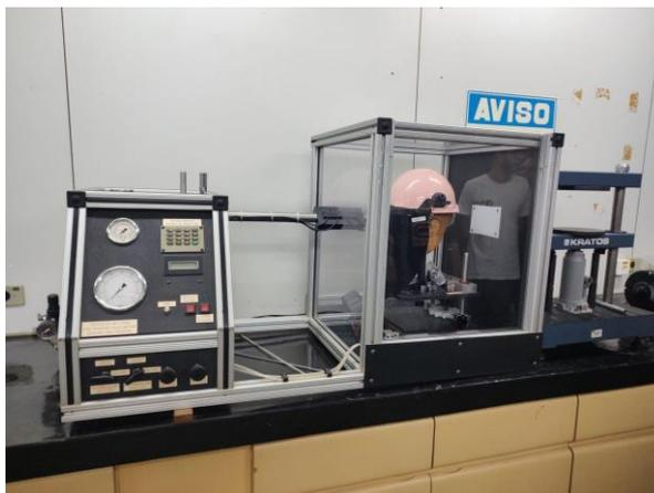
Máquina utilizado para ensaio da resistência de impacto dos óculos de segurança
