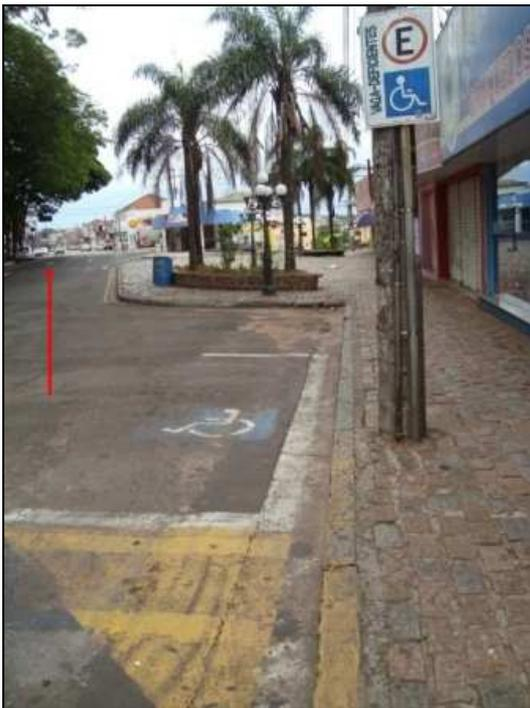
Figura 65 - Vaga em 45° inadequada.
