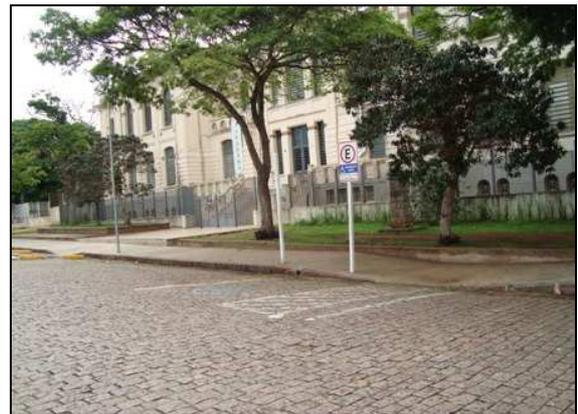
Já nas Figuras 62 e 63, observa-se erro no projeto da vaga destinado à PCDs, pois não há rebaixamento de calçada junto á guia, além de obstáculos muito próximos e o piso irregular.
