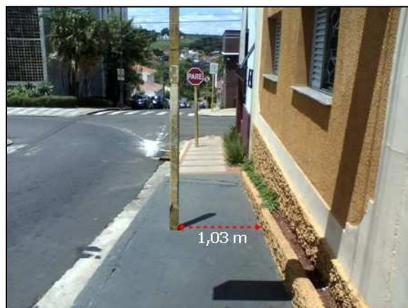
A Figura 13, demonstra que o espaçamento para o passeio público está adequado, pois o orelhão foi instalado corretamente, em contrapartida a Figura 14 indica um espaço inferior ao recomendado pela NBR – 9050 (apenas 1 metro de faixa livre), dificultando a circulação, além de não existir nenhum tipo de sinalização de alerta.
