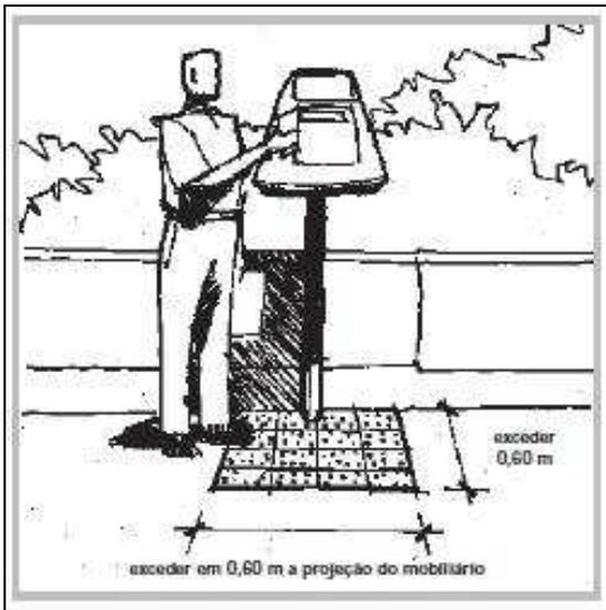
Figura 16 - Obstáculo suspenso projetado de forma irregular na calçada.
