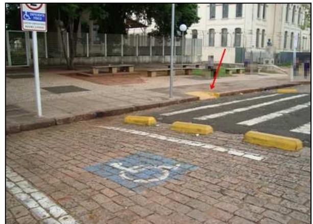
Conforme a NBR – 9050, a implantação de vagas reservadas para veículos que conduzem ou são conduzidos por pessoas com deficiência não pode ter desníveis acima de 1,5cm, portanto há necessidade de rebaixamento de calçada quando necessário.
