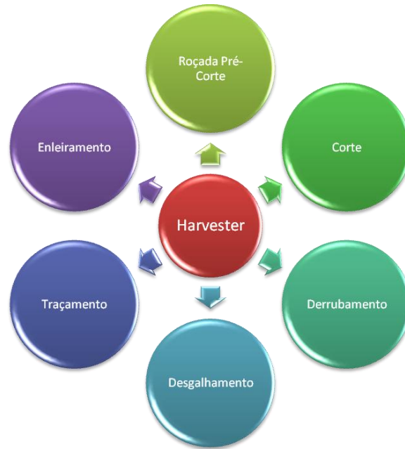
Figura 13 – Substituição das etapas da colheita pelo Harvester
