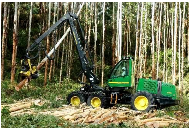
Figura 12 - Máquina utilizada na colheita mecanizada - Harvester
