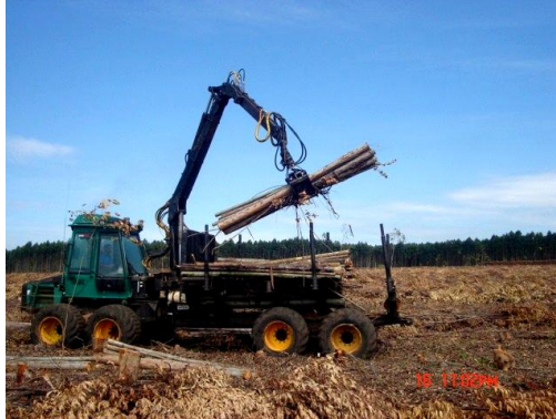
Figura 9 - Etapa da remoção da madeira com Forwarder
