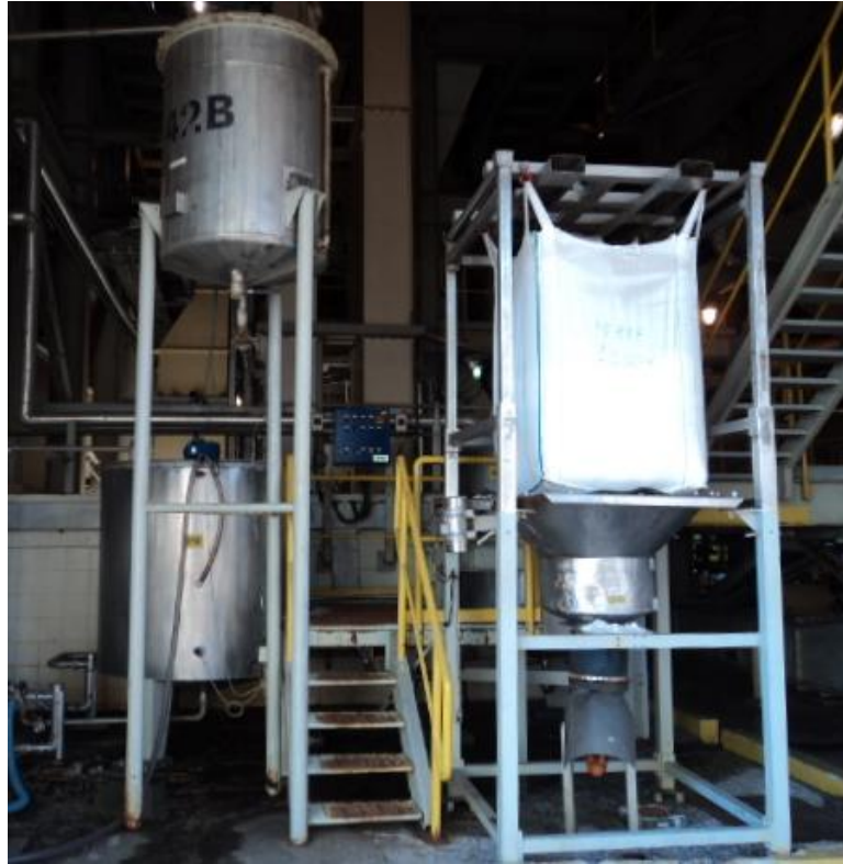
Figura 14- Armazenagem e preparo do catalisador
