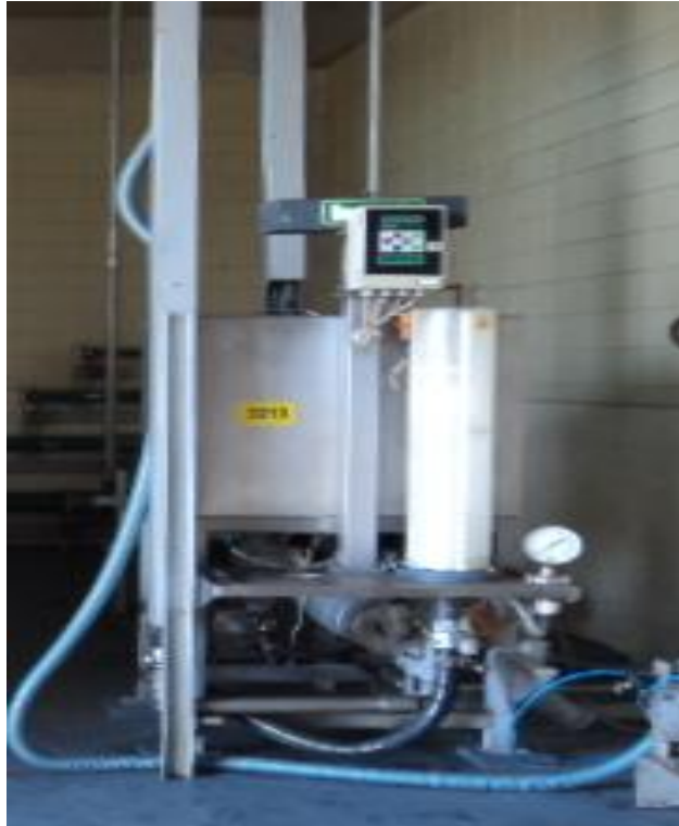
Figura 13- Cilindros de dosagem de emulsão
