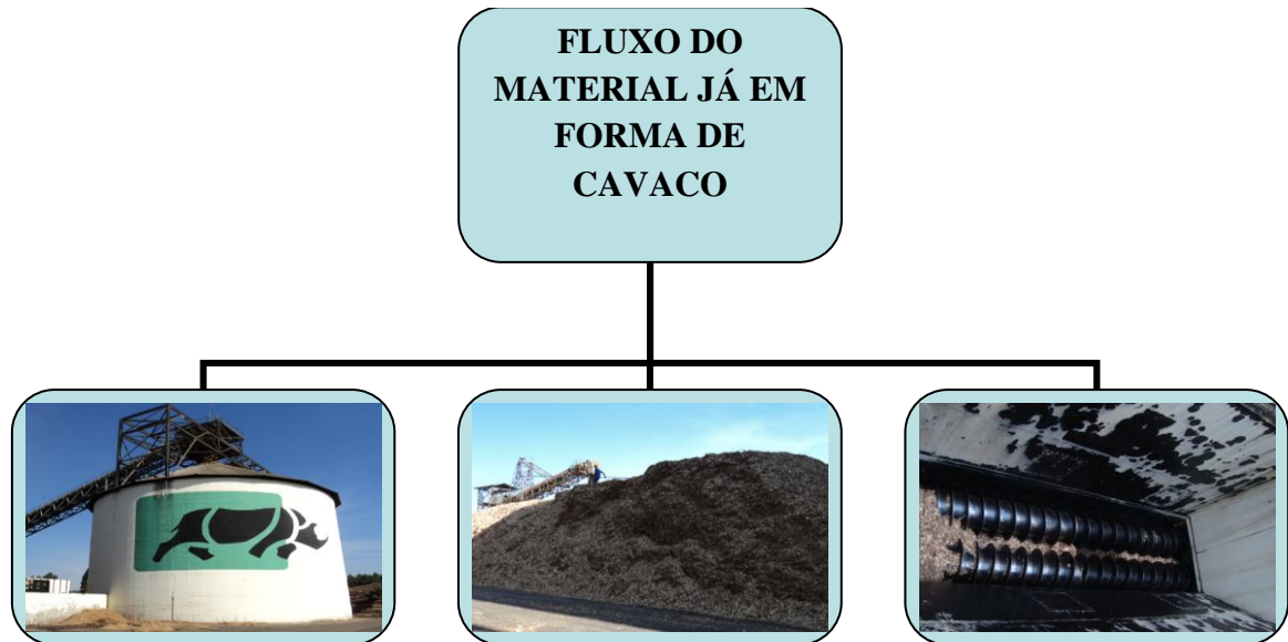
Figura 4- Silo do maracanã, Pátio externo de cavaco, Rosca extratora de alimentação Externa
