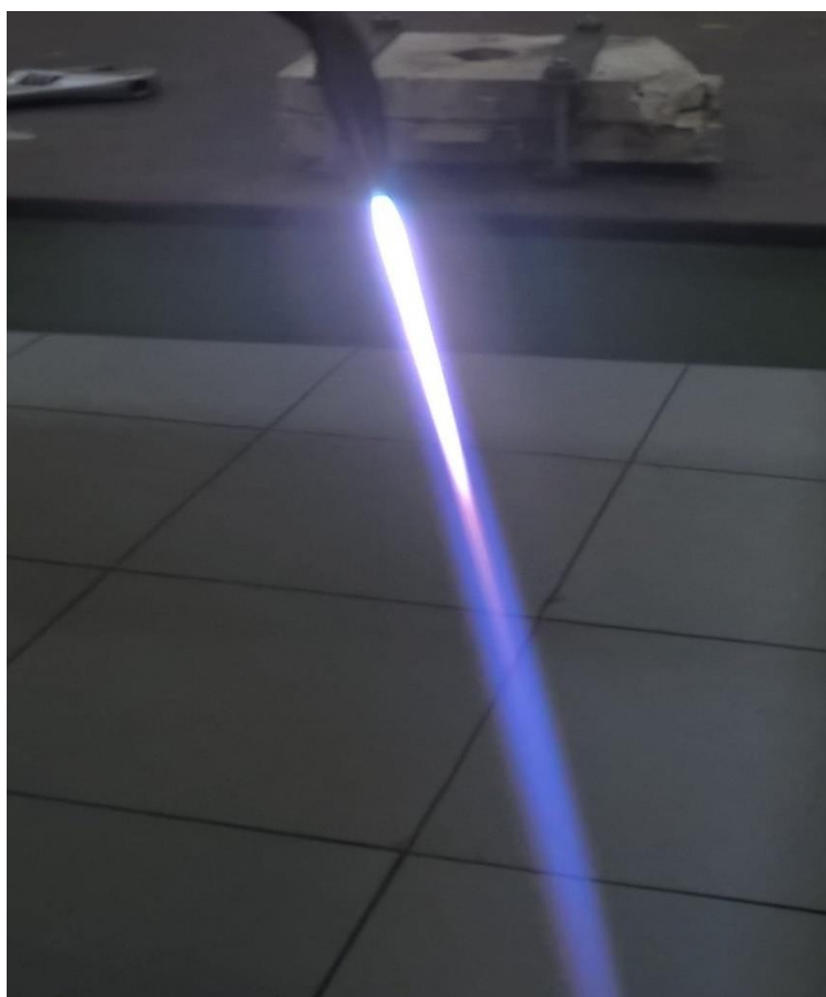
Figura 3 – Regulagem da chama neutra oxiacetileno (Dardo branco, brilhante e penacho alongado).
