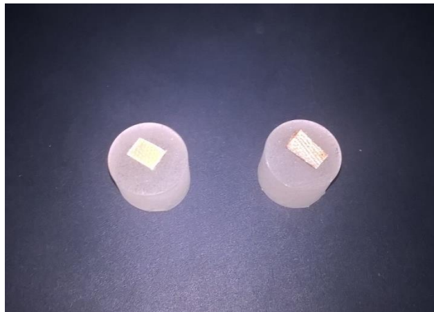
Figura 5 – Amostras embutidas em acrílico para análise microscópica.
