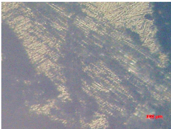
Figura 9 - Microscopia da área soldada do PEI-Fibra de vidro após teste lap shear (Pior resultado).
