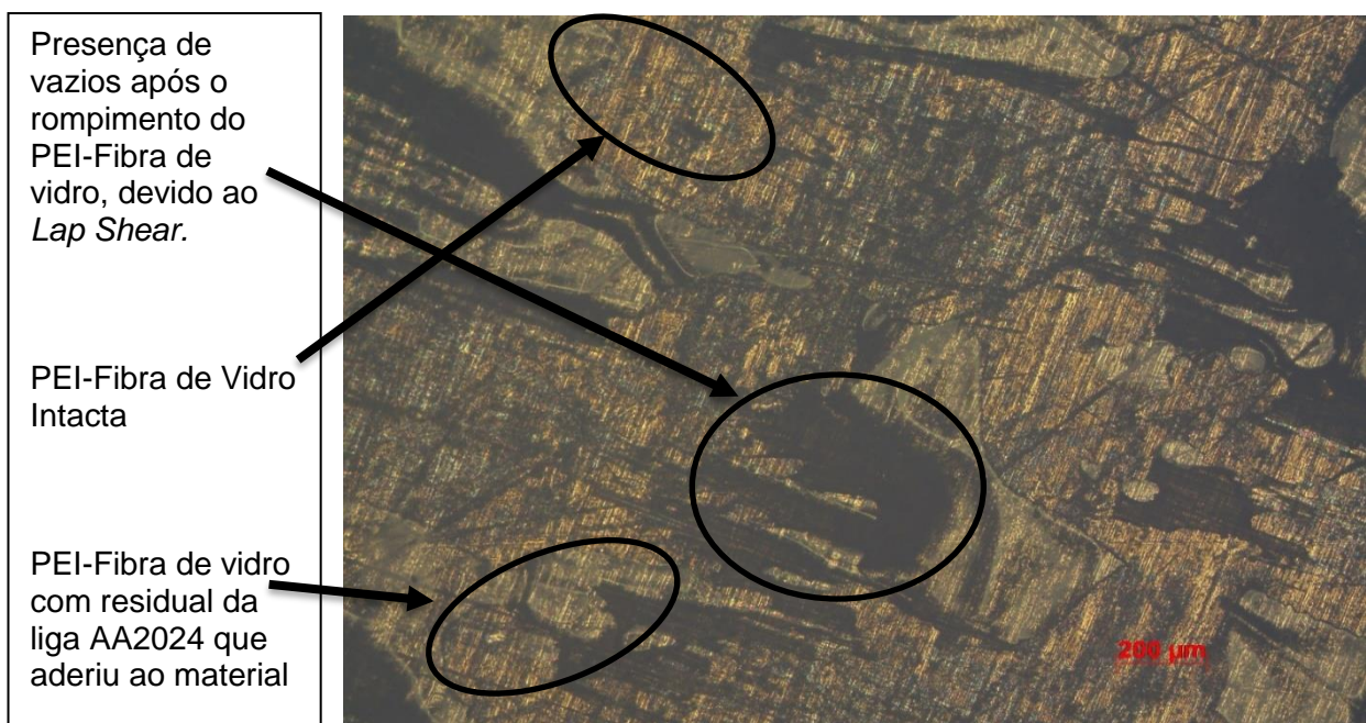
Figura 8 – Microscopia da área soldada do PEI-Fibra de vidro após teste lap shear (Melhor resultado).
