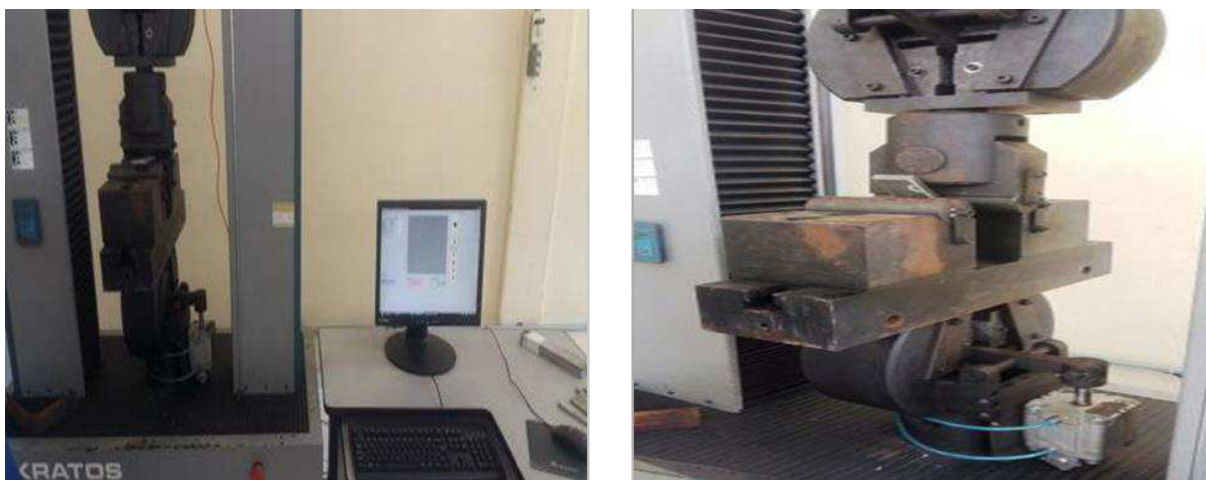
Figura 7 - Máquina de ensaio dobramento, computador e sistema de dobramento guiado Fonte – Elaborado pelos autores
