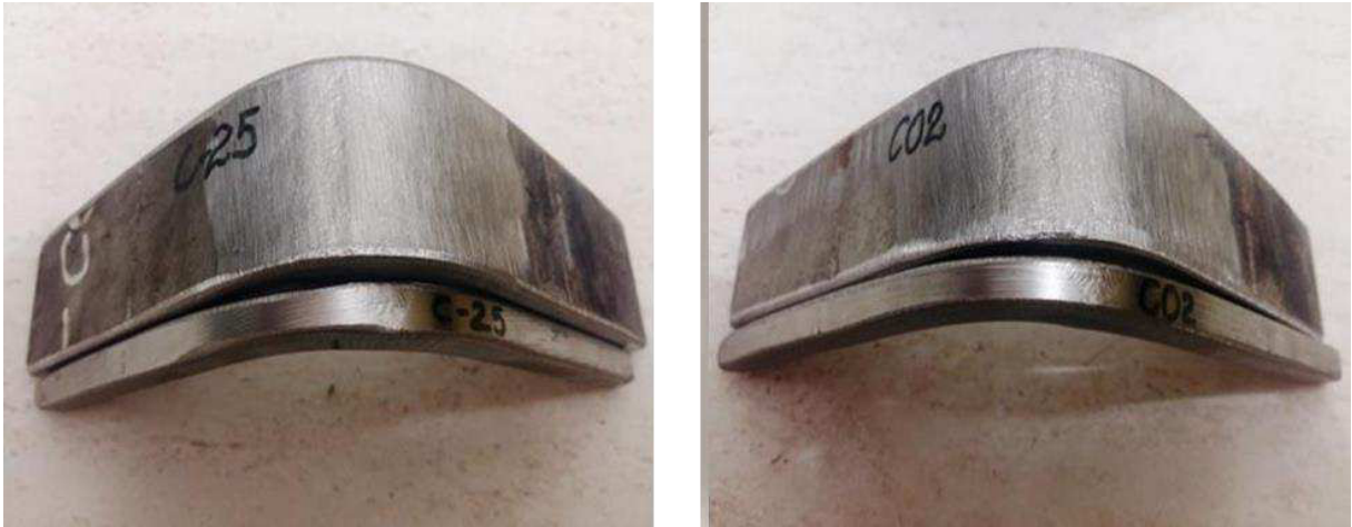
Figura 19 – Corpos de prova, detalhe da área soldada depois do ensaio de dobramento
