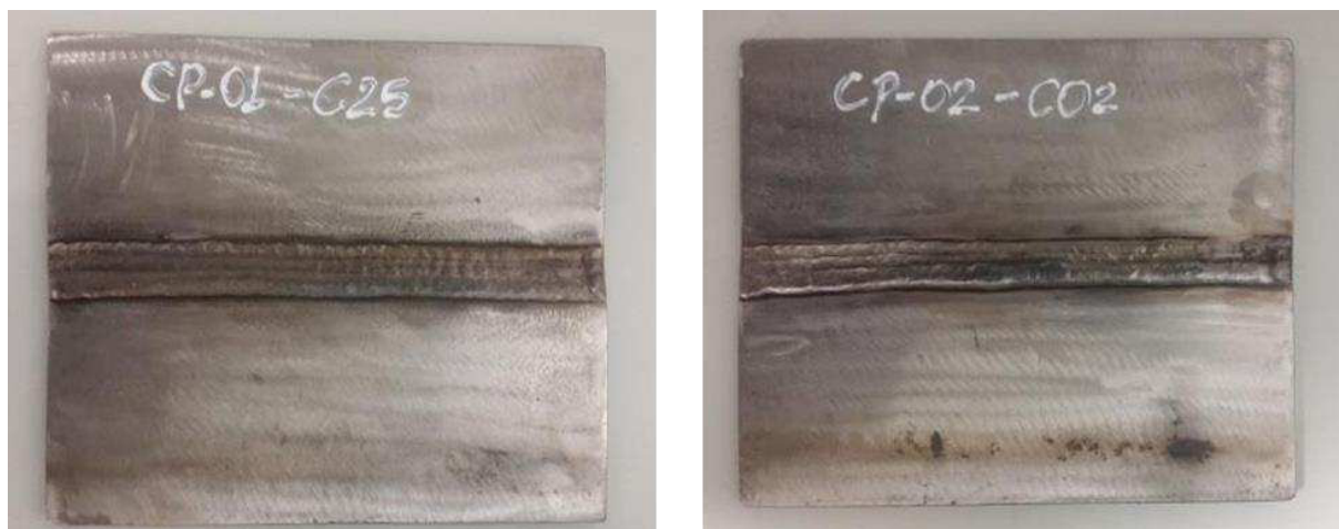
Figura 5 - Corpos de prova soldados com gás C-25 e com gás CO 2 Fonte – Elaborado pelos autores
