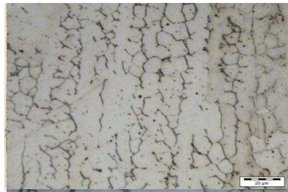
Solda executada com gás CO 2 . Microscópio Óptico
