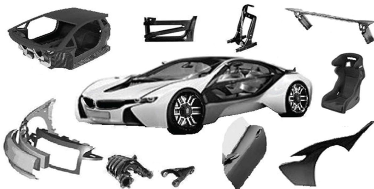
Figura 12 – Componentes automotivos que utilizam a fibra de carbono
