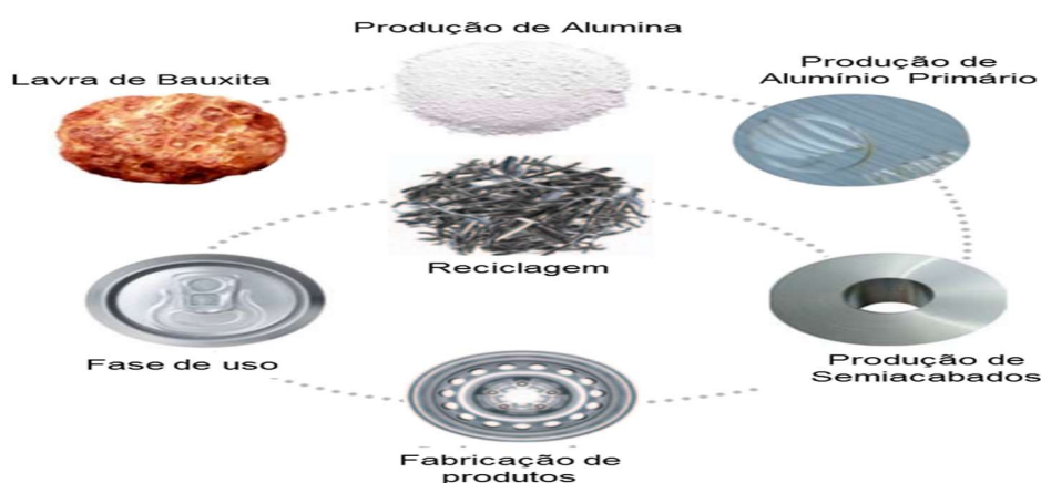
Figura 6 – Processo de produção do alumínio
