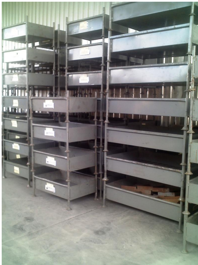
Figura 8. Embalagens metálicas de uso interno
