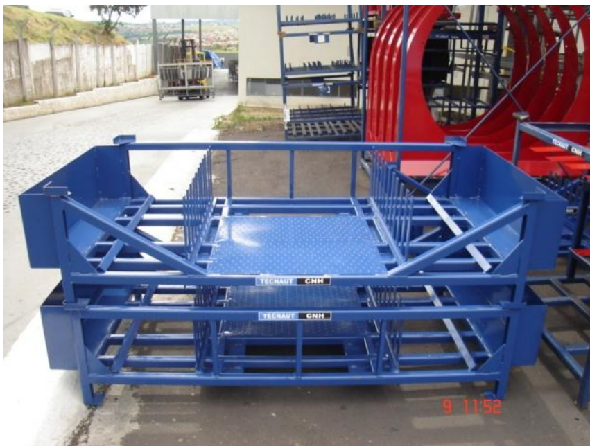
Figura 10. Embalagens metálicas de transporte com maior capacidade
