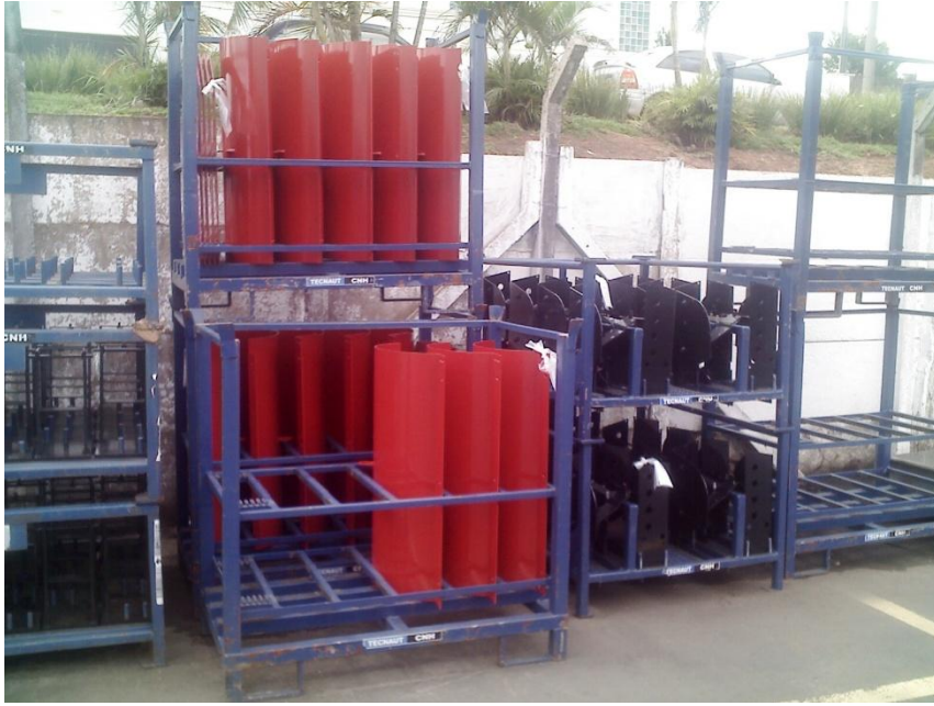
Figura 9. Embalagens metálicas de transporte com menor capacidade
