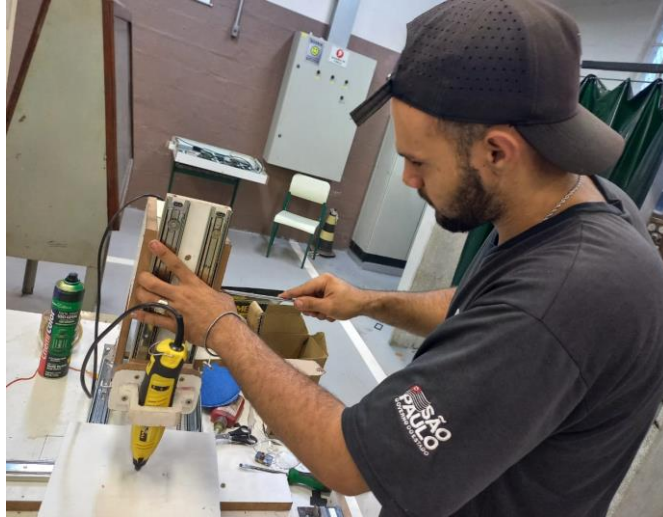
Figura 12 - Fixação das correias no eixo Z. Fonte: Autoria própria.
