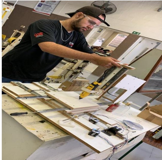
Figura 11 - Instalação da base de madeira para o motor Fonte: Autoria própria.
