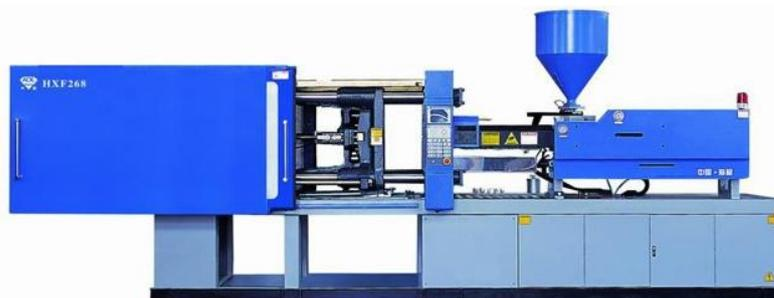
Figura 5: Máquina injetora de plástico.
