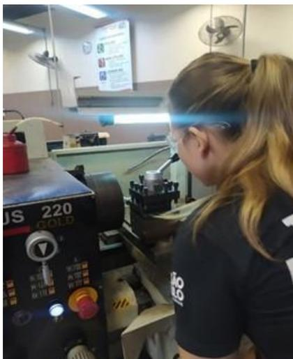
Figura 10: Usinando as colunas cortadas no torno.
