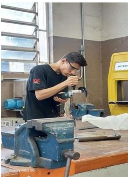
Figura 13: Corte da chapa para a estrutura do funil.
