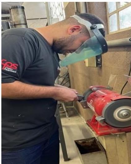
Figura 14: Efetuando os ajustes nas rebarbas do apoio.
