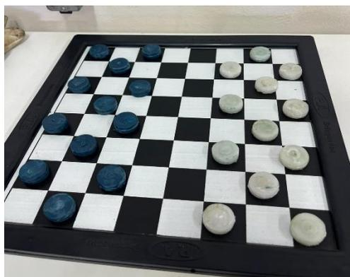
Figura 20: Tabuleiro de dama com as peças feitas pelo protótipo de mini máquina injetora de polipropileno
