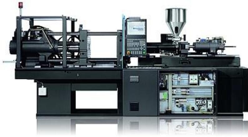
Figura 1: Máquina injetora hidráulica.
