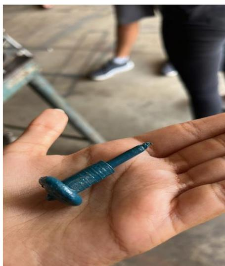
Figura 18: Primeira peça injetada durante os testes
