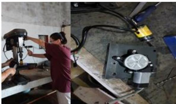
Figura 8: Furação das placas laterais e a fixação dos motores
