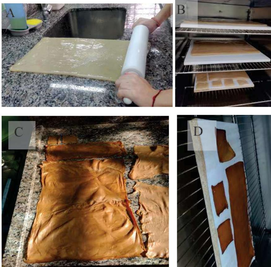
Figura 4: A) Biotecido sendo espremido com rolo de massa de plástico. B) Primeira amostra na estufa antes da secagem. C e D) Amostra já seca. Fonte: Própria (2023).
