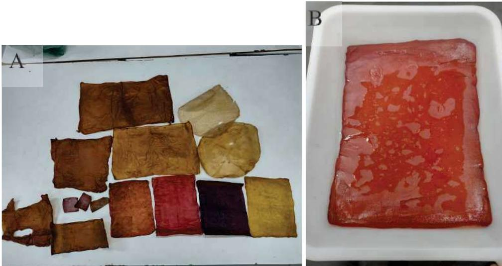
Figura 6: A) Todas as amostras secas. B) Amostra com duas camadas de óleo de linha e com aspecto gorduroso. Fonte Própria (2023).
