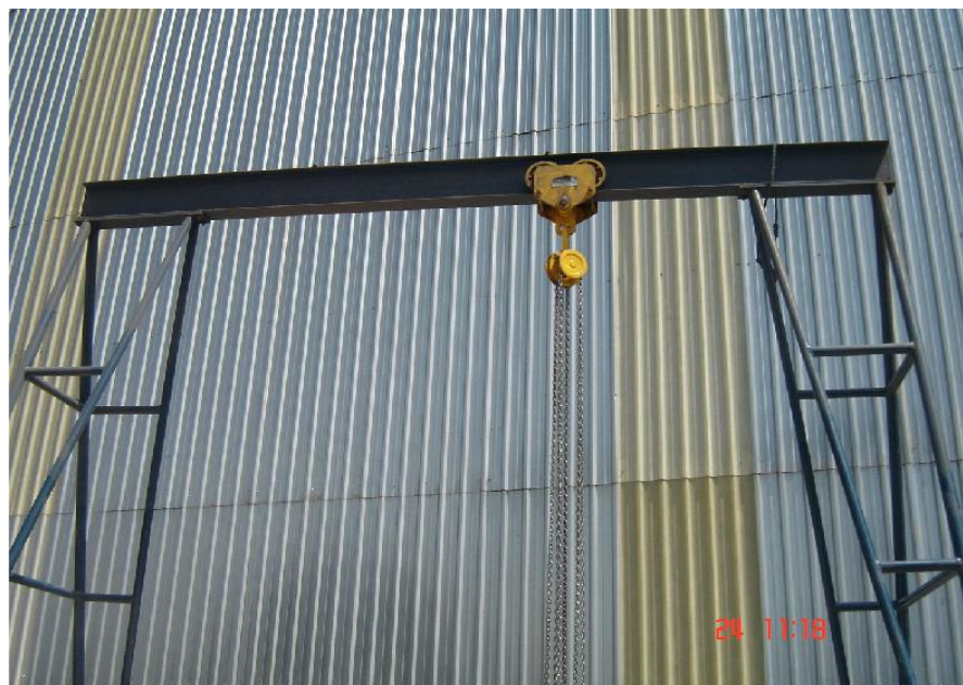
Figura 13 – 2º Pórtico com talha manual existente na empresa
