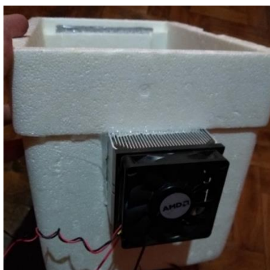
Figura 15 - Fixação do dissipador com a pastilha peltier
