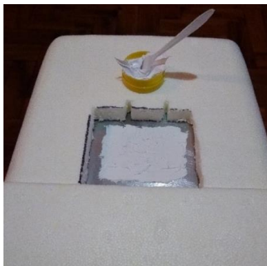
Figura 14 - Pasta térmica do lado externo da chapa
