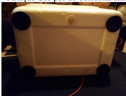
Figura 17 - Fixação dos pés de borracha antiderrapante
