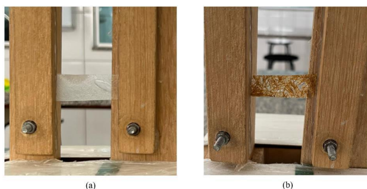
Figura 8 - Teste de tração com o bioplástico sem fibra (a) e com fibra (b)
