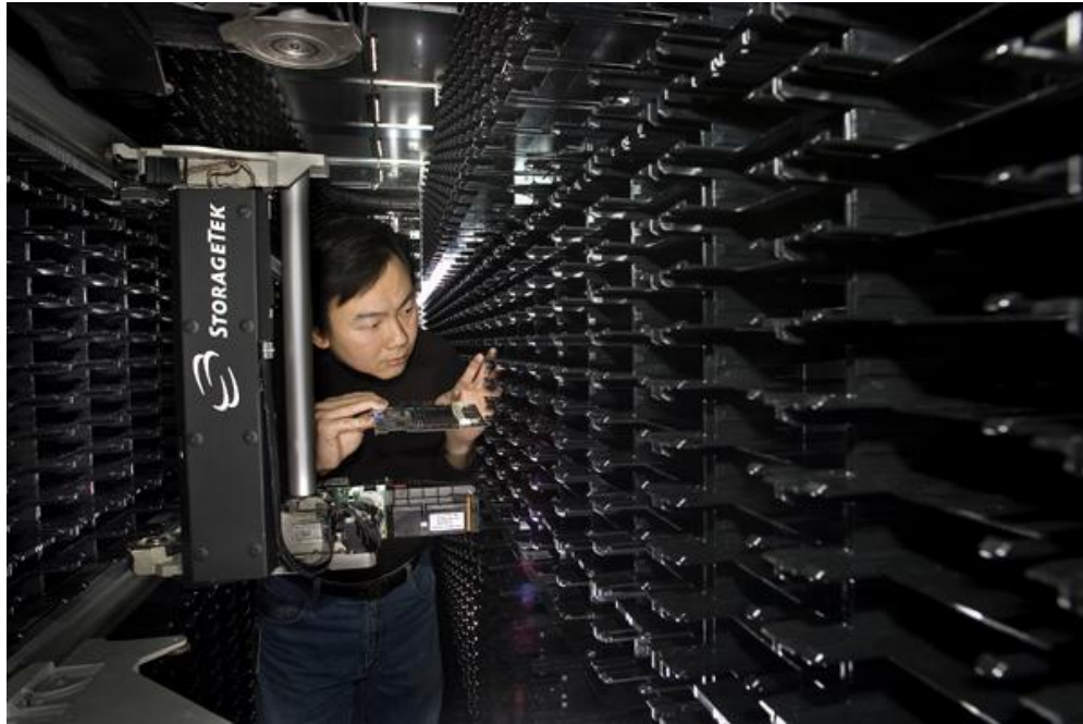
Figura 6: Interior de uma ATL ( Automatic Tape Library )
