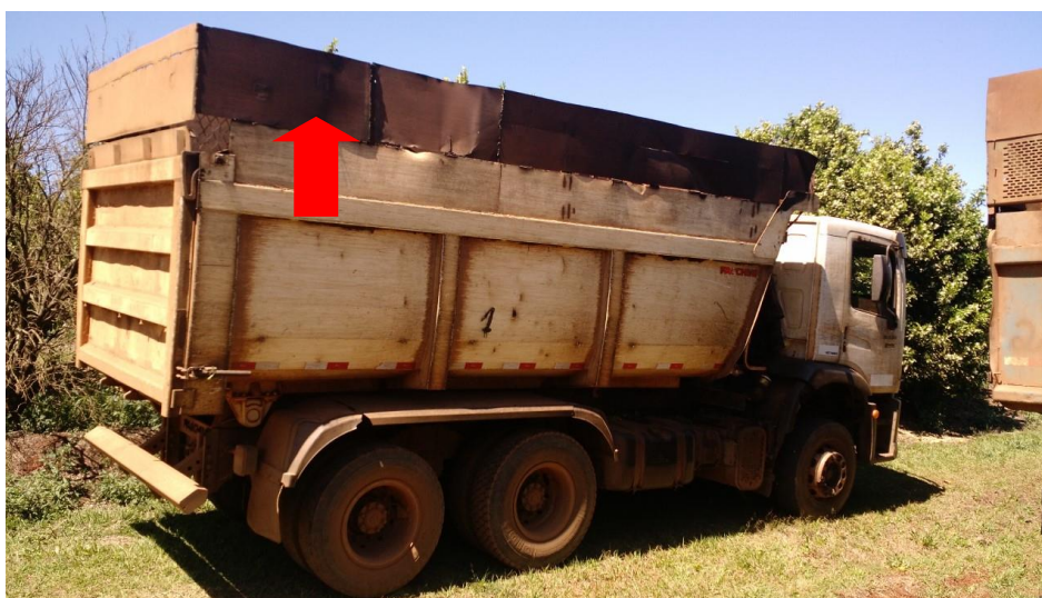
Figura 9 - Chapa para aumentar capacidade da caçamba
