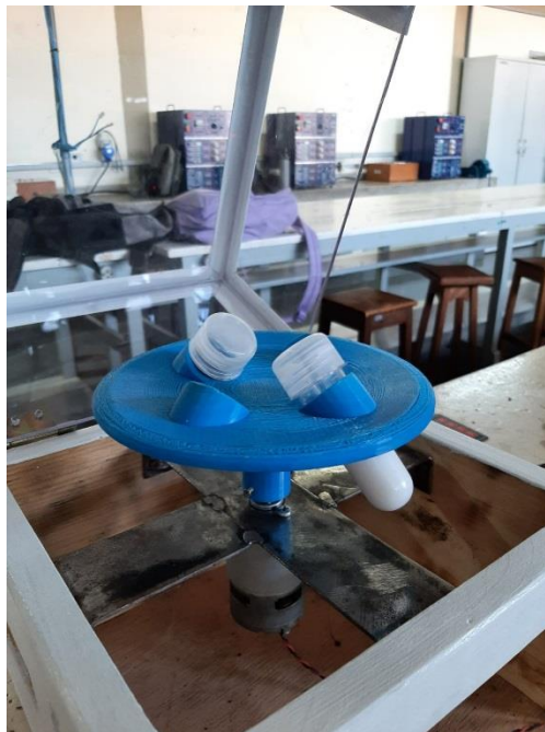
Figura 17- Teste da centrífuga com as amostras
