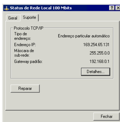
Figura 3 - Placa configurada com endereço APIPA.
