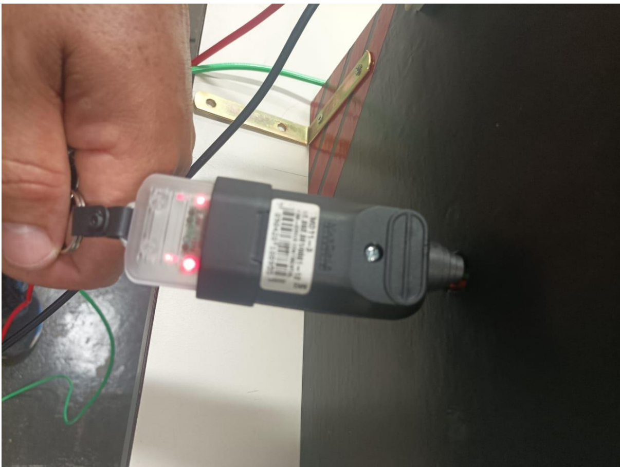
Figura 16 - Teste da tomada com pino teste identificando 220V.
