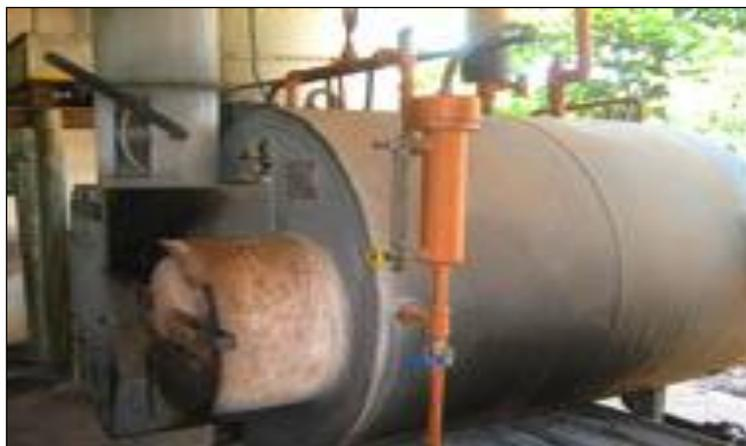
Figura 7- Utilização do caldeirão no processo de destilação da cachaça.
