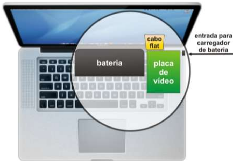
Figura 24 - Ilustração de componentes internos do laptop mais predispostos a emitir radiação eletromagnética.
