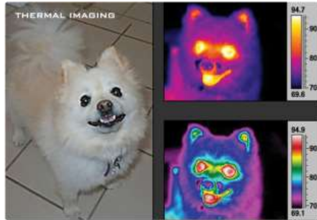
Figura 7 - Ilustração captada por uma câmera de radiação infravermelha exibindo o mapa térmico de um cachorro. Os pontos mais escuros (violeta) são os mais frios (70° Fahrenheit ou 21° Celsius), enquanto que os pontos mais claros (próximo do vermelho) são os que estão mais quentes (94° Fahrenheit ou 34° Celsius). Fonte: NASA (BUTCHER, 2010).
