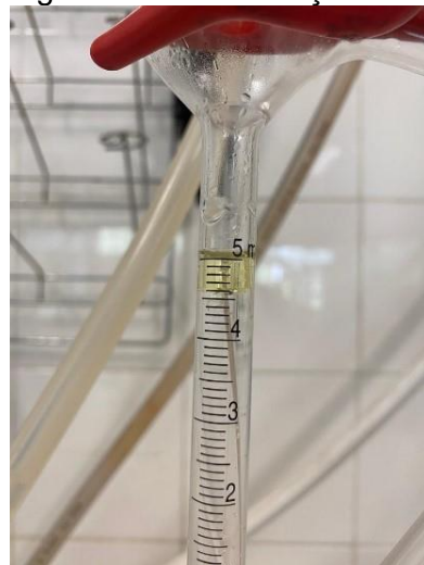
Figura 4 – Condensação do óleo
