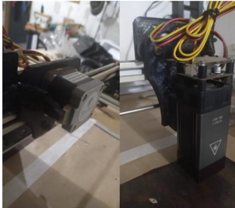
*Figura 18: Visão frente e verso do Eixo X e seu motor.*
