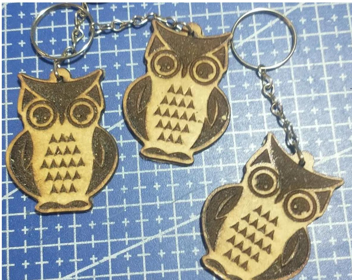
Figura 28: Gravação e Corte em material MDF 2,5mm de baixa densidade
