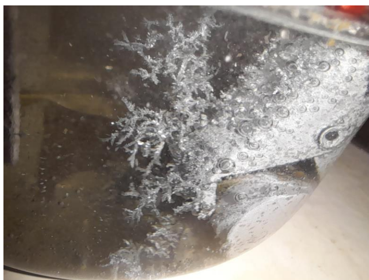
Figura 2 – Acúmulo de zinco sendo atraído do cátodo em direção ao ânodo. A ramificação lembra bastante os galhos de uma árvore.
