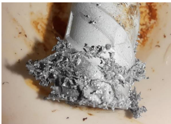
Figura 4 – Vergalhão de aço logo após a zincagem, apresentando lascas superficiais.
