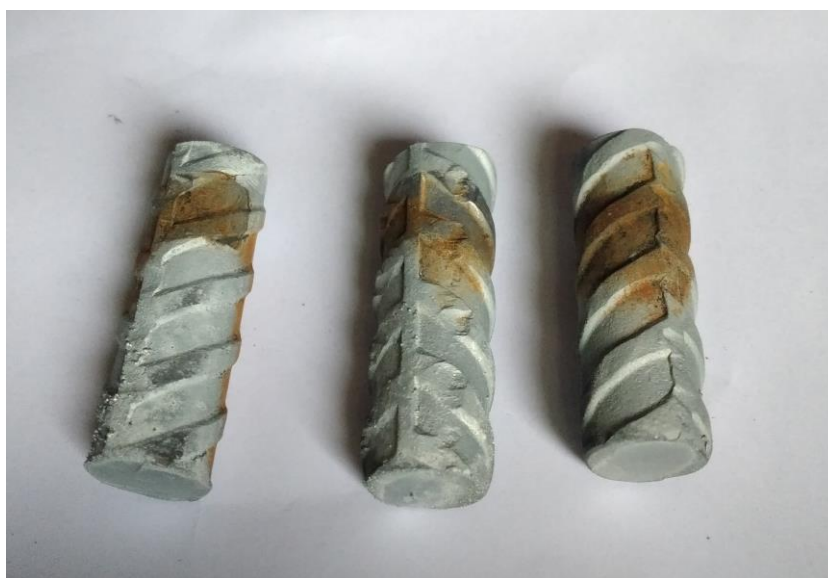
Figura 5 – Resultado da parcial zincagem após 2 semanas em ambiente úmido e salino. Na superfície zincada, não houve oxidação ou qualquer tipo de oxidação. Já na parte onde o aço não foi protegido, a oxidação se iniciou em menos de um dia.
