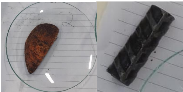
Figura 3 – Chapa de zinco corroída após o término do procedimento (no vidro de relógio), juntamente do vergalhão escurecido recém-saído da eletrólise.
