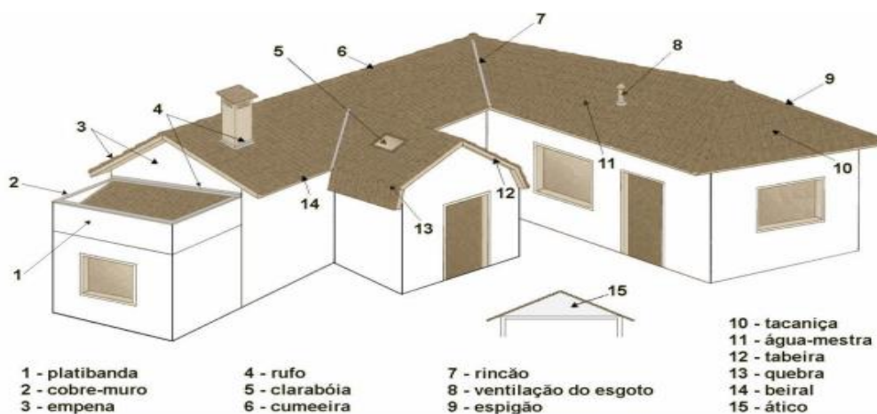
Figura 1: Designações dos elementos da cobertura de telhado
